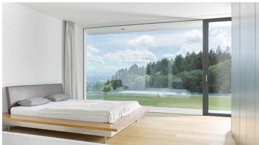
L' **isolamento termico** di una finestra dipende dal materiale del telaio, dalla vetrata e dalla tenuta. Il parametro con il quale si indica la capacità isolante di una finestra è il valore U. Quanto minore è tale valore, tanto migliore sarà l'isolamento termico. L' **isolamento acustico** di una finestra dipende dal materiale del telaio, dal vetraggio e dalla impermeabilità delle fughe. Viene indicato in dB. Tanto meglio chiude la finestra, tanto migliore sarà l'isolamento acustico.
