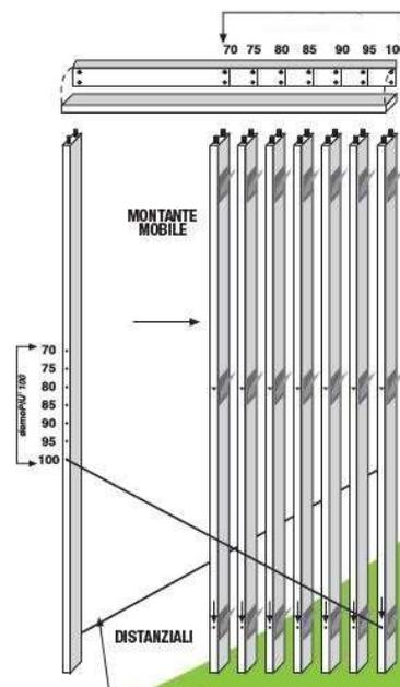
**Istruzioni per il montaggio del controltaio pronto per porte da 90cm, ma utilizzabile per 7 diverse larghezze di porte**
