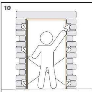
Posizionare il controltaio in modo che il livello sia ad 1m dal pavimento finito e fissare al muro
